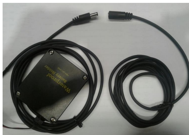
Abb. 18 – Batteriekorb und Kabel zum Anschluss
